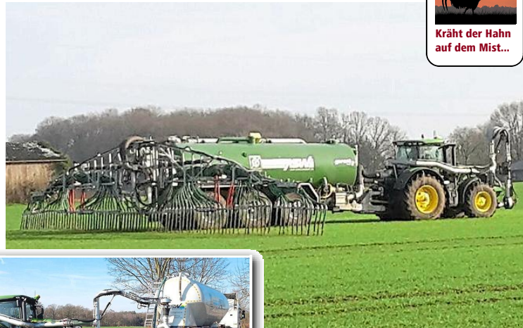
Gülle wird heute kaum noch mittels eines herkömmlichen Pralltellers ausgebracht. Eine der modernen Ausbringtechniken ist das Schlepplachverfahren. Außerdem beliefen Lkw die Güllefässer auf den Feldern (kl. Bild). So bleiben die Straßen sauber. Fotos: ASW
