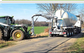
Gülle wird heute kaum noch mittels eines herkömmlichen Pralltellers ausgebracht. Eine der modernen Ausbringtechniken ist das Schlepplachverfahren. Außerdem beliefen Lkw die Güllefässer auf den Feldern (kl. Bild). So bleiben die Straßen sauber. Fotos: ASW
